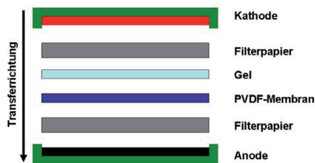
Abbildung 15. Aufbau der „Semi-Dry Western Blot“-Apparatur.
