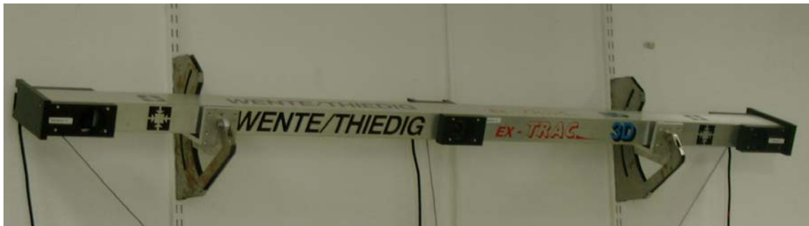
Abb. 2: Aluminium-Profil mit Messkameras (CCD-Kameras links und rechts, Videokamera Mitte)
