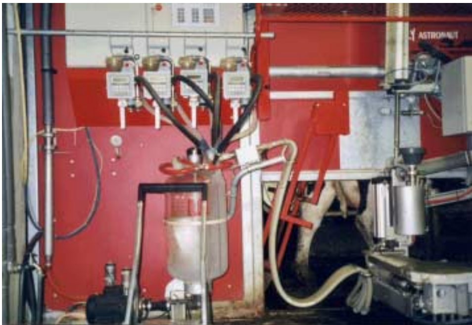
Abb. 9: Einbau der vier LactoCorder am AMS.
