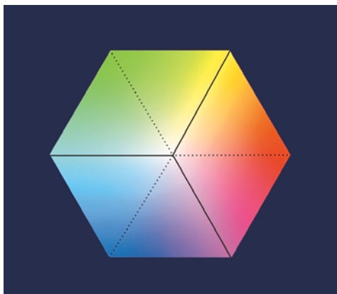
Abb. 4a: Jede horizontale Schnittfläche der HSV-Pyramide ist die Projektionsfläche eines RGB- (Teil-) Würfels (s.a. Farbtafel II/4a)
