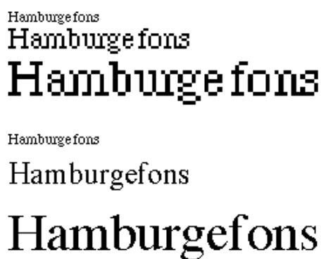
Abb. 1: Skalierung eines Bitmap-Fonts und eines TrueType-Fonts.
