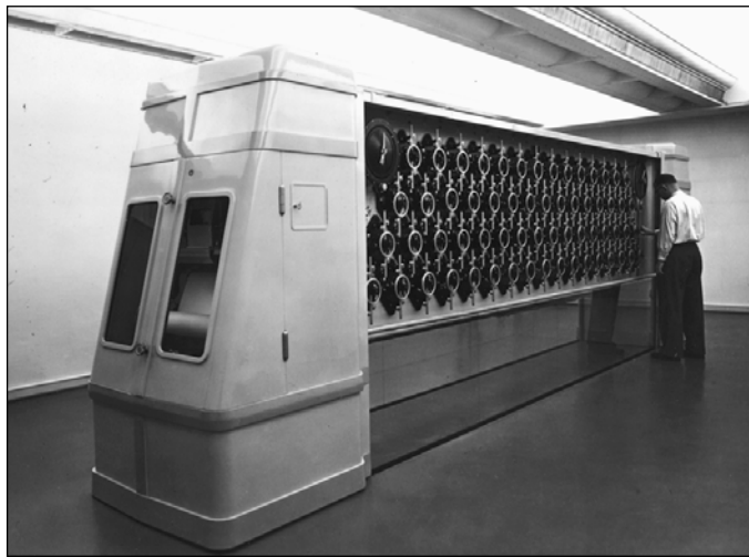
Abb. 1: Gezeitenrechenmaschine des Deutschen Museums München. Die für das Deutsche Hydrographische Institut in Hamburg hergestellte Maschine gilt als die größte der Welt (s. SAGER, 1955, S. 69).
