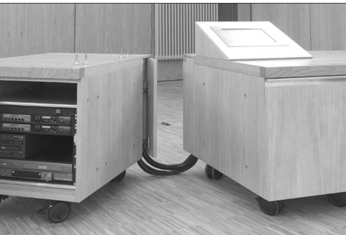
Abb. 8; Verbindung der Module des mobilen Pultsystems
