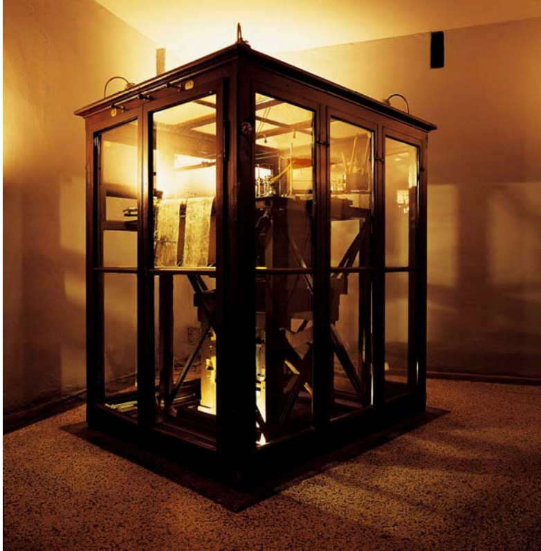
Fig. 5 - Seismometre Wiechert © B. Braesch – UDS
