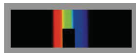
Abb. 10 Photodokumentation des Ausgangsbilds für die gleichzeitige Weiß- und Purpursynthese [I.N. 2009]. Oben zeigt die Abbildung ein Foto des Newtonspektrums (wie in Abb. 8 oben). Unten zeigt sie ein Foto des Newtonspektrums, dessen grüne Mitte von Nussbaumer herausgeschnitten wurde (wie in Abb. 9 oben). Dieses zweizeilige Ausgangsbild ist durchs Prisma zu betrachten. Abb. 11 zeigt, was bei diesem Experiment herauskommt.
