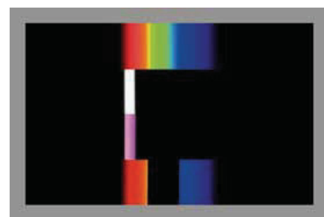
Abb. 11 Gegenüberstellung der gleichzeitigen Weiß- und Purpursynthese [I.N. 2009]. In der Mitte (Zeile 2 und 3) zeigt sich das Resultat, das man erhält, wenn man durchs Prisma auf das Ausgangsbild (Abb. 10) blickt. Die Photodokumentation dieser beiden Versuchsergebnisse belegt: Beide Synthesen liefern Bilder mit exakt identischen Abmessungen.
