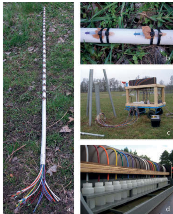
Abb. 20: Beispiel eines Multilevel-Piezometers (a). Die vom Rohrinernen nach außen geführten Schläuche sind mit einer Gaze als Filtermaterial ausgestattet und mit Kabelbindern an der Haltestange fixiert (b). Auf einer mobilen Vorrichtung befinden sich die Mehrkanalpumpe inklusive farblich kodierter Anschlussschläuche (c) sowie eine Haltevorrichtung für Probengefäße (d). (Fotos: Jörg Lewandowski, Franziska Pöschke, Katharina Amelung).
