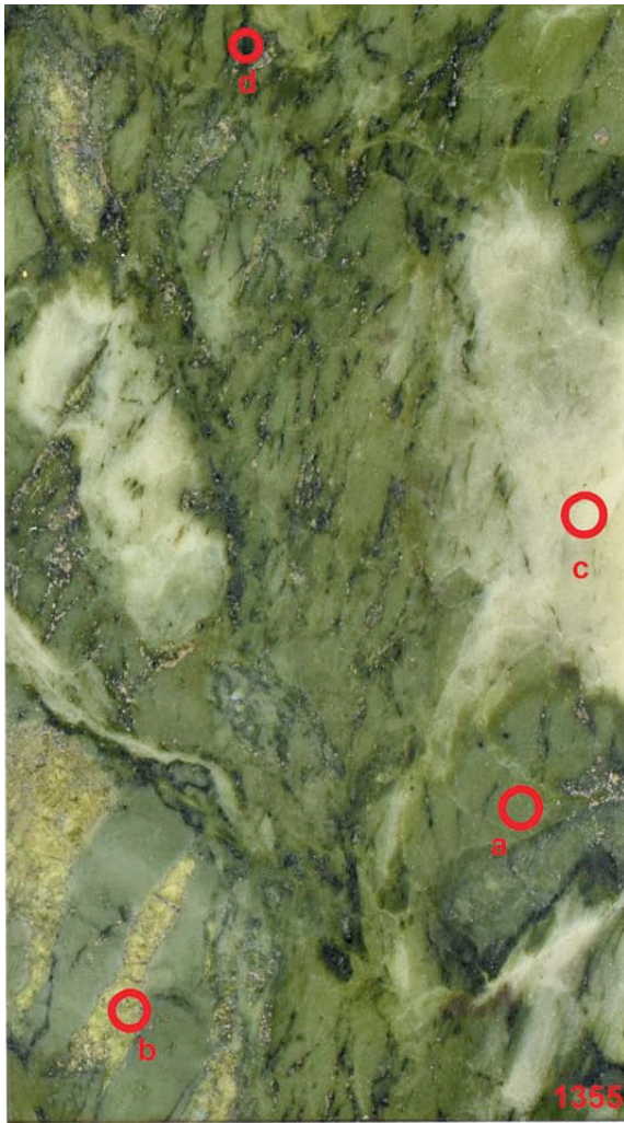
Abb. 4: Tafel mit der Inventarnummer 1355, „Schiefer“. An den rot eingekreisten Stellen wurden die Farbcodes nach Munsell aufgenommen (a = grayish olive, 10Y 4/2; b = dusky yellow, 5Y 6/4; c = yellowish gray, 5Y 7/2; d = greenish black, 5GY 2/1). Petrographische Sammlung der TU Freiberg, Sammlung Kolywan (Cotta). Foto: Anja Weber
